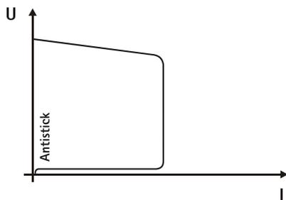
**Устройство Antistick предотвращает прокаливание электрода.**
